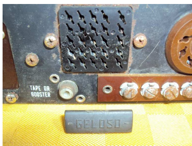
Spina per selezionare l'impedenza degli altoparlanti
