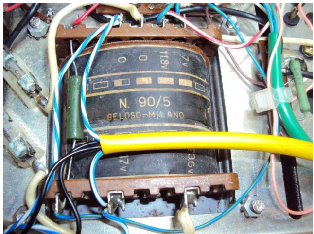
Trasformatore di alimentazione
