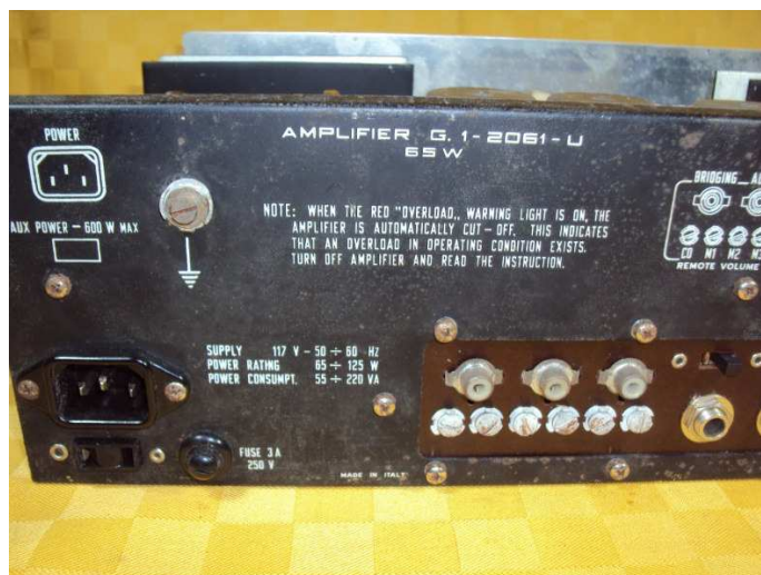
Presa alimentazione e ingressi Aux
