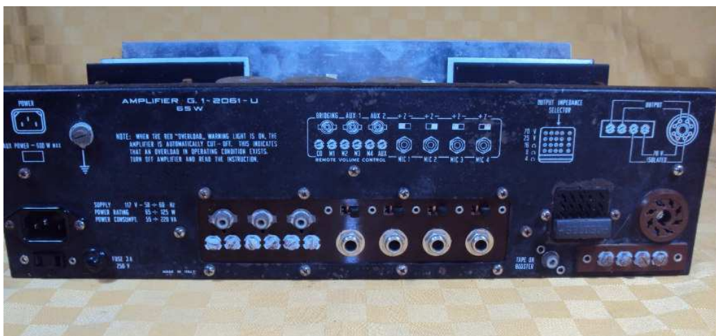
Amplificatore con ingressi e uscite dal retro
