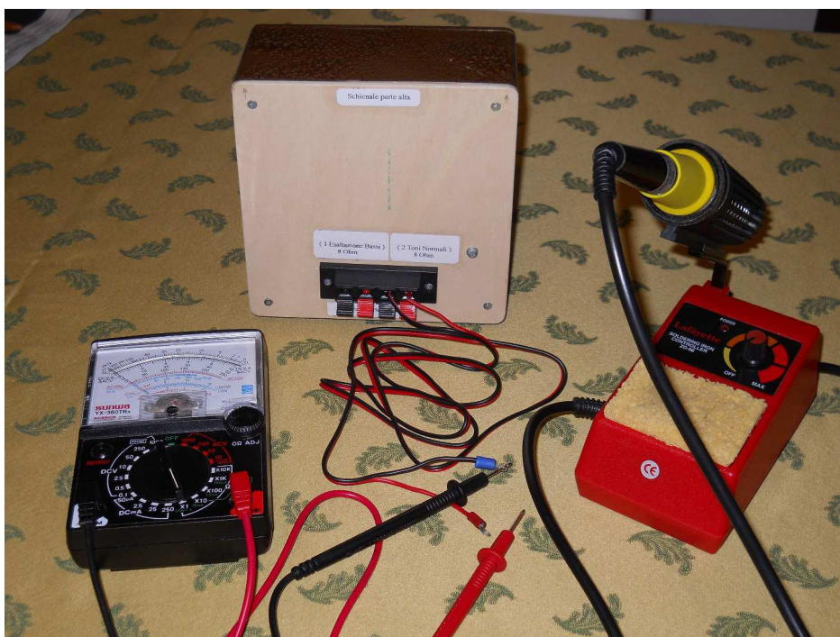
Pannello posteriore con uscite doppie : Toni normali -Toni bassi.
