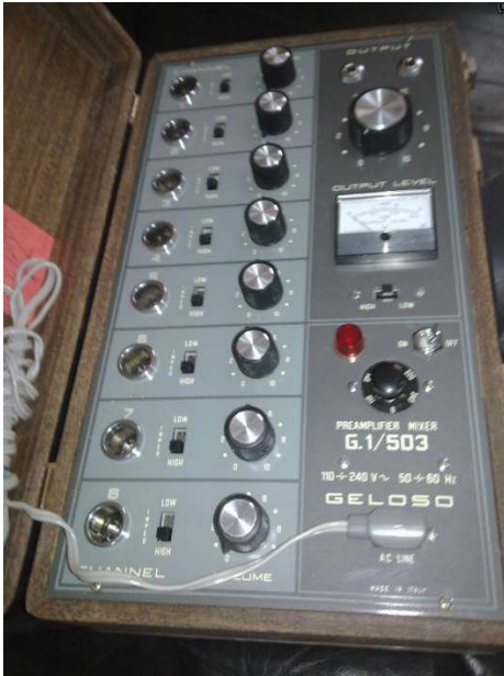
Mixer G1/503 con strumento controllo segnale
