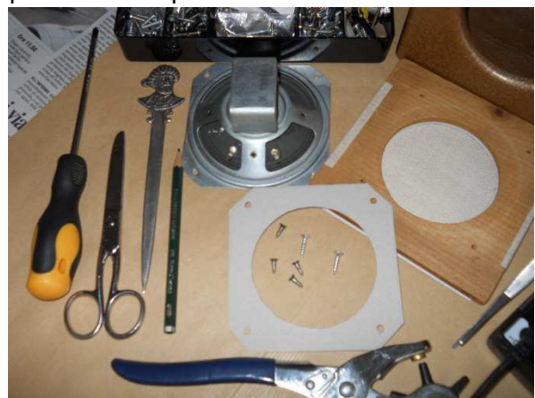
rifacimento dischi guarnizione in cartone
