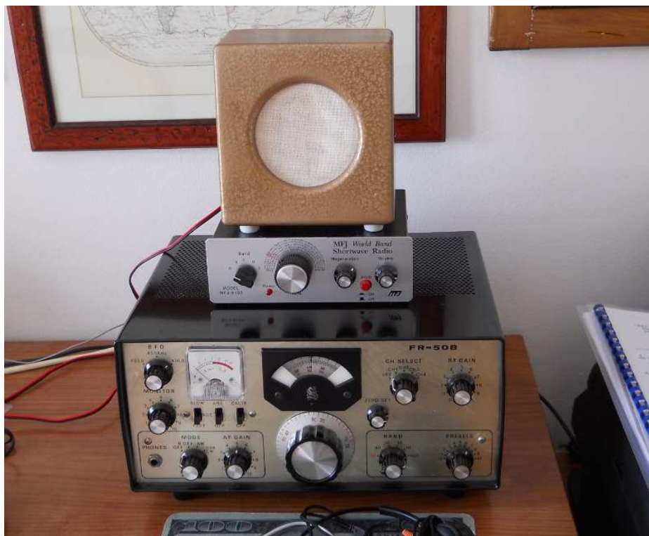
Diffusore in opera collegato a RX Sommerkamp FR50-B
