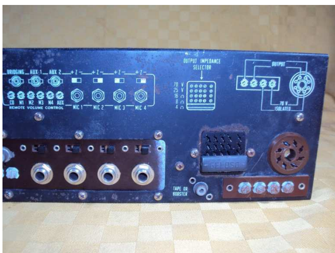
I quattro ingressi micro con selettori H.L .
